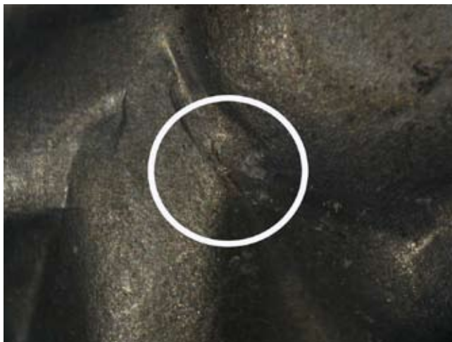
Egy olyan repedés közeli képe, amelyet a megfelelő specifikációkhoz képest 12%-kal vastagabb tömítés okozott. Túl nagy lett a távolság az első és az utolsó lemez között.
